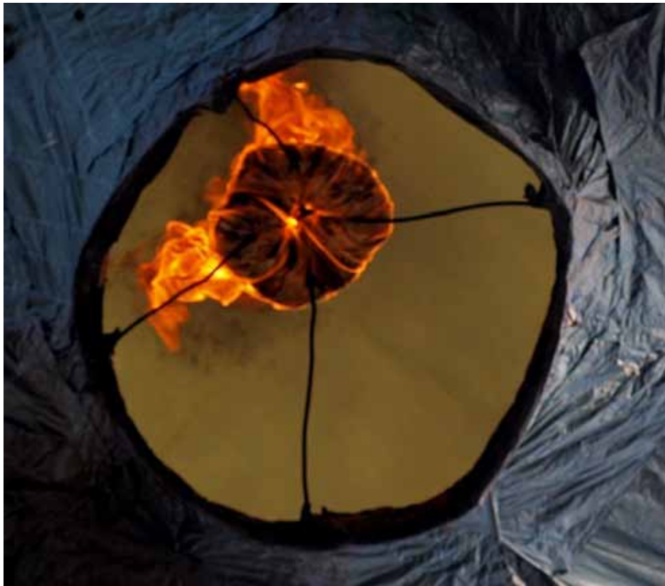
La boquilla de un globo y la ardiente dona, previéndole de energía para su elevación
